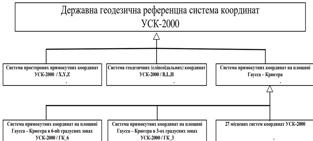
Рис. 4.7. UML – діаграма структури Державної геодезичної референцної системи координат USK-2000
