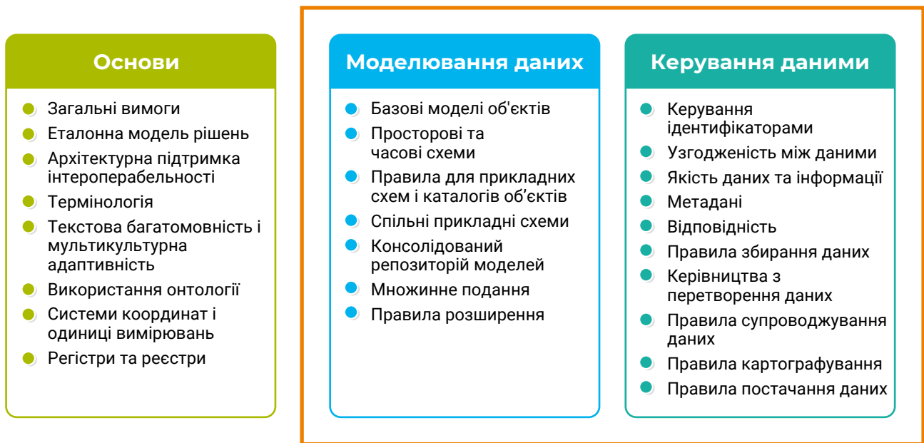
Рис. 3.3. Узагальнена система елементів забезпечення інтероперабельності геопросторових даних НІГД згідно із практикою INSPIRE (адаптовано авторами; джерело [86])
