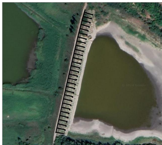
Рис. 4.25. Приклади зображення об'єкта типу «Гідротехнічні споруди» на ортофотопланах (берег з закріпленим відкосом)
