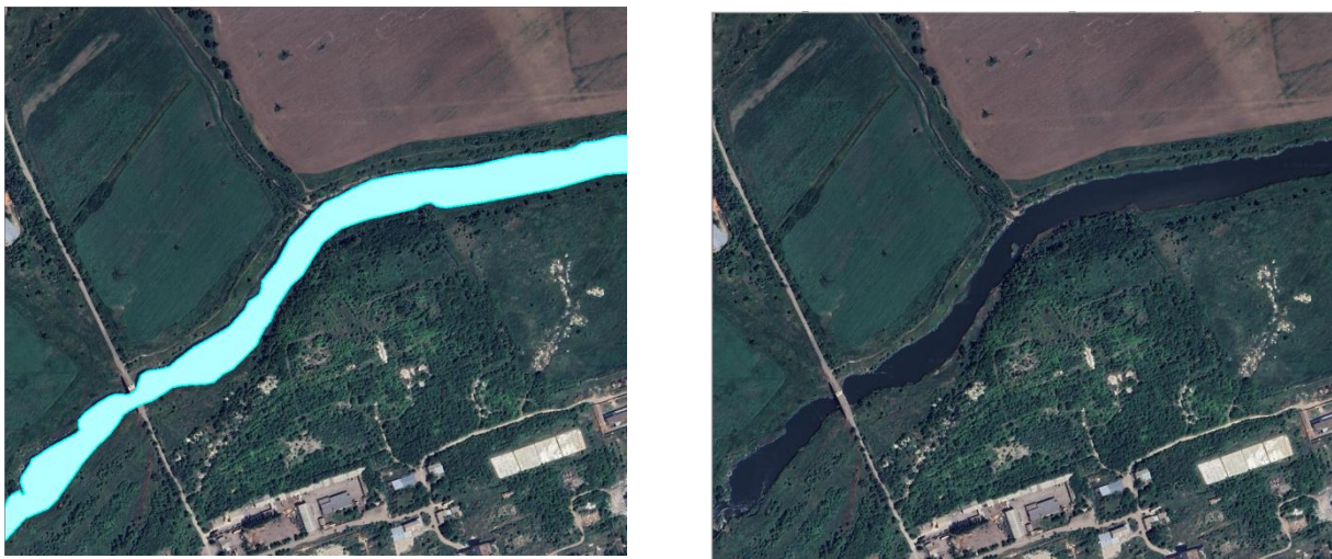
Рис. 4.38. Приклади зображення об'єкта типу «Ділянки водотоків та каналів гідрографічної мережі» на ортофотопланах (річки і водотоки, полігон)
