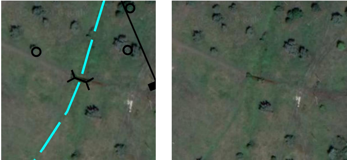
Рис. 4.85. Приклади зображення об'єкта типу «Мостові споруди» на ортофотопланах (пішохідний міст)
