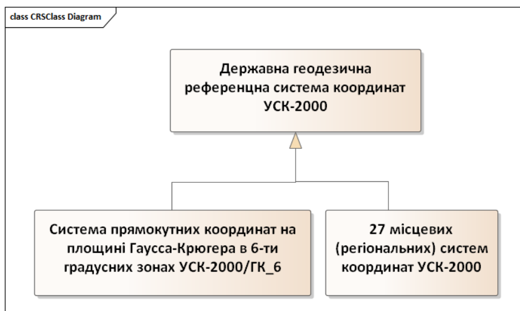
Рис. 5.2. UML – діаграма структури референцної системи координат для створення /оновлення топографічних карт
