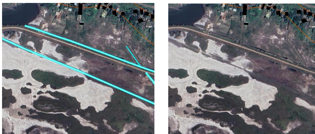
Рис. 4.16. Приклади зображення об'єкта типу «Ділянки водотоків та каналів гідрографічної мережі» на ортофотопланах (канал)
